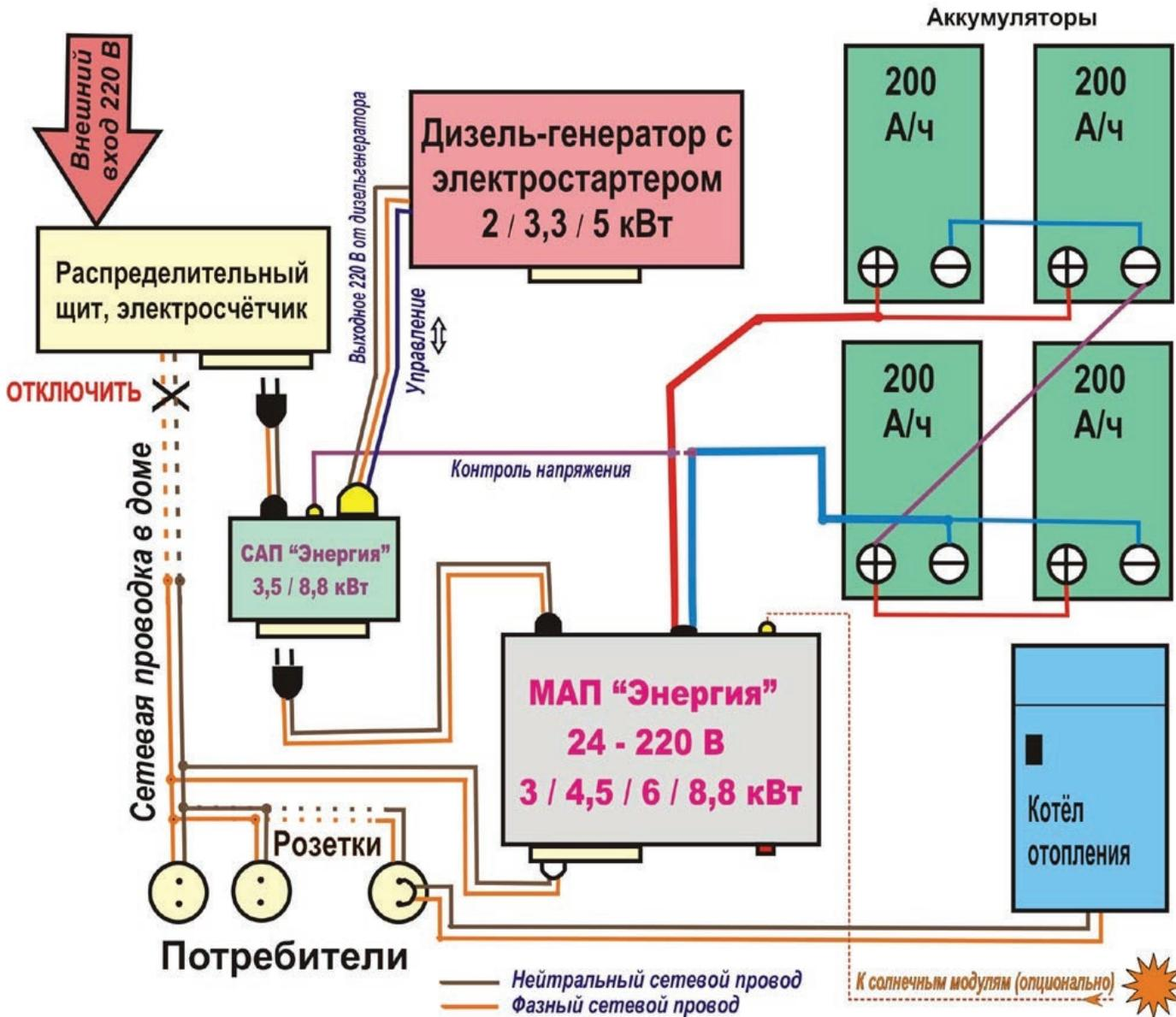
4) Когда напряжение на АКБ достигнет верхнего порога (программируется в меню САП) или при появлении в сети напряжения 220 В, САП дает команду на выключение миниэлектростанции.
