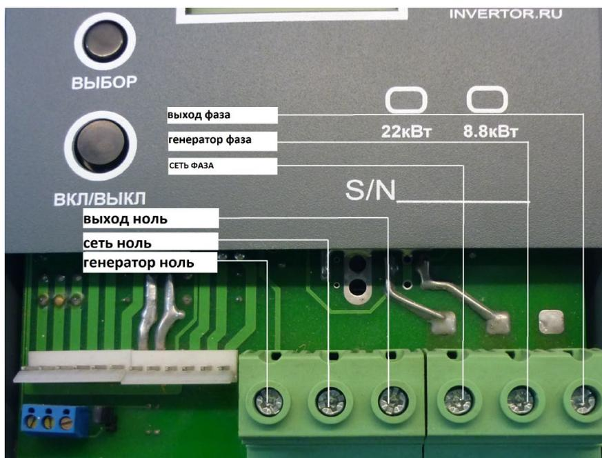
Схема подключения силовых проводов для САП 5.0 (размещается на крышке)
