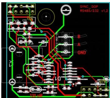
Для старой версии 1.2 подключение стандартное трехпроводное полудуплексное (gnd, A, B). Также возможно подключение через разъем RJ45 - X7 (1,2 - +5v; 3,4 - B; 5,6 - A; 7,8 - gnd).
